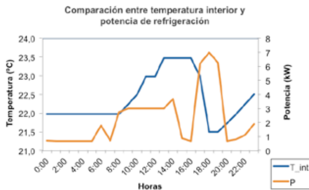
Gráfico 8. Ejemplo de resultado gráfico obtenido con un registrador de temperatura.
