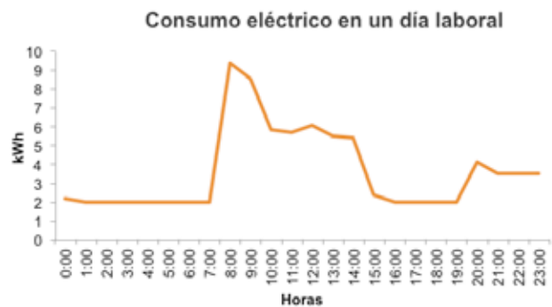
Gráfico 7. Ejemplo de resultado gráfico obtenido con un analizador de redes en una oficina.
